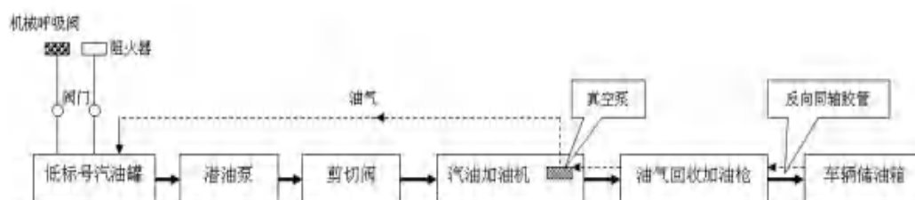
图 2.3-3 汽油加油工艺流程图
