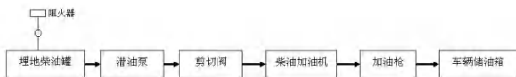
图 2.3-4 柴油加油工艺流程图
