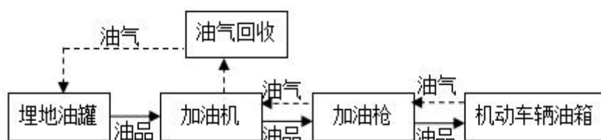
图 2.4-3 汽油加油工艺流程图
