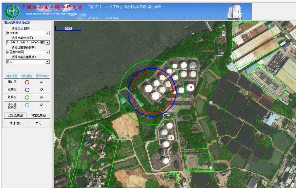
图 8.2-3 容器整体破裂池火事故后果图
