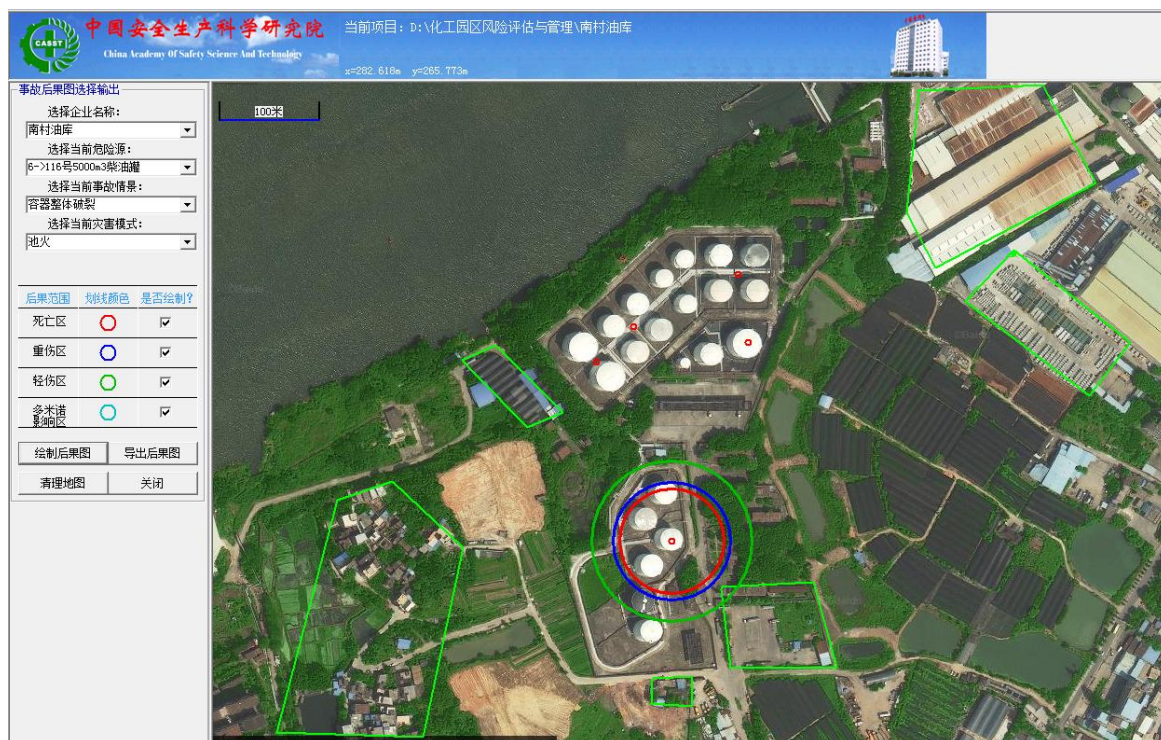
图 8.2-4 容器整体破裂池火事故后果图
