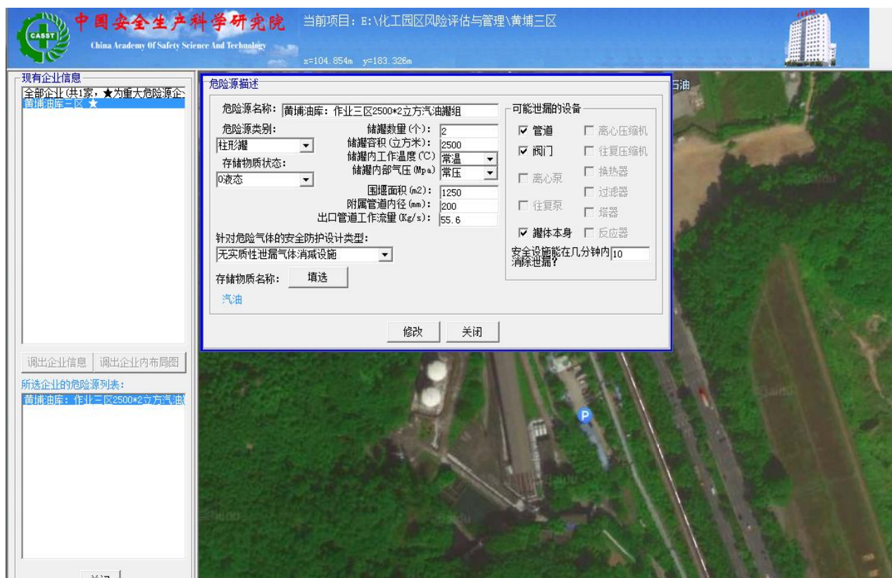
图 7.3-9 作业三区 2500m³×2 汽油罐组事故后果模拟参数
