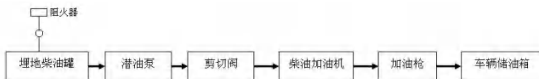
图 2.5.1-4 柴油加油工艺流程图
