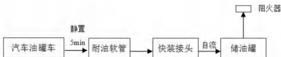
图 2.3-2 柴油卸油工艺流程图
