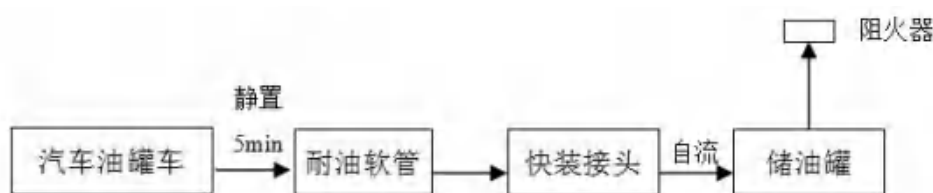
图 2.3-2 柴油卸油工艺流程图
