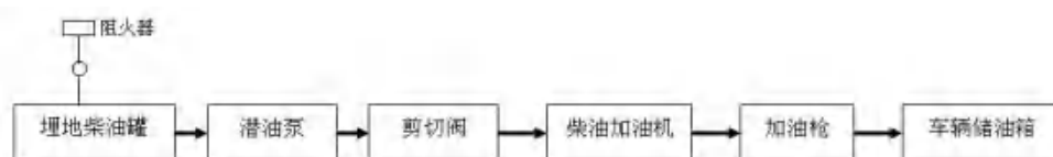
图 2.3-4 柴油加油工艺流程图
