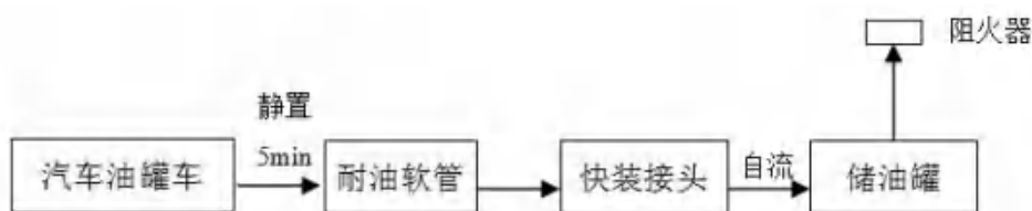
图 2.3-2 柴油卸油工艺流程图
